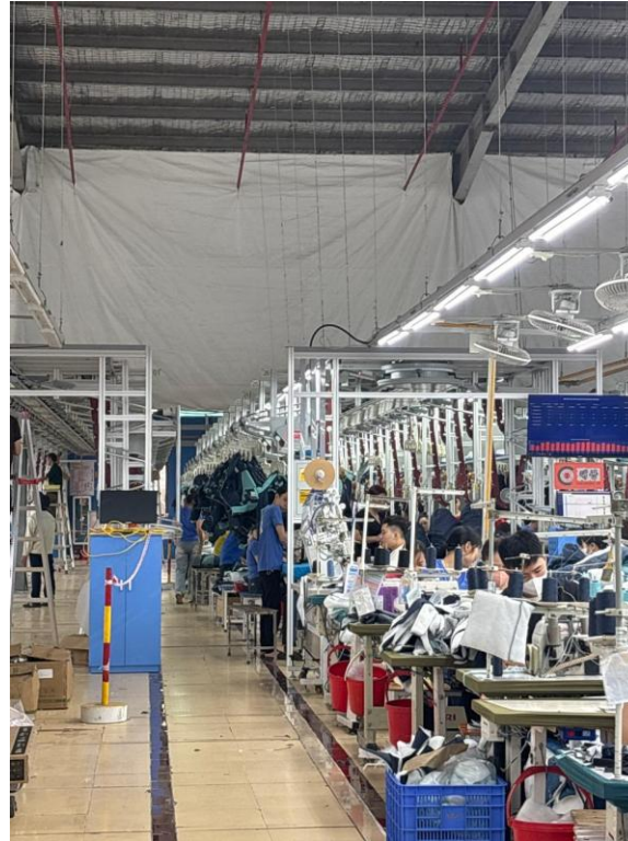
Khu chuyền treo (hỗ trợ tăng năng suất 15% so với chuyền may truyền thống; chi phí đầu tư 600-700 triệu đồng/chuyên)
