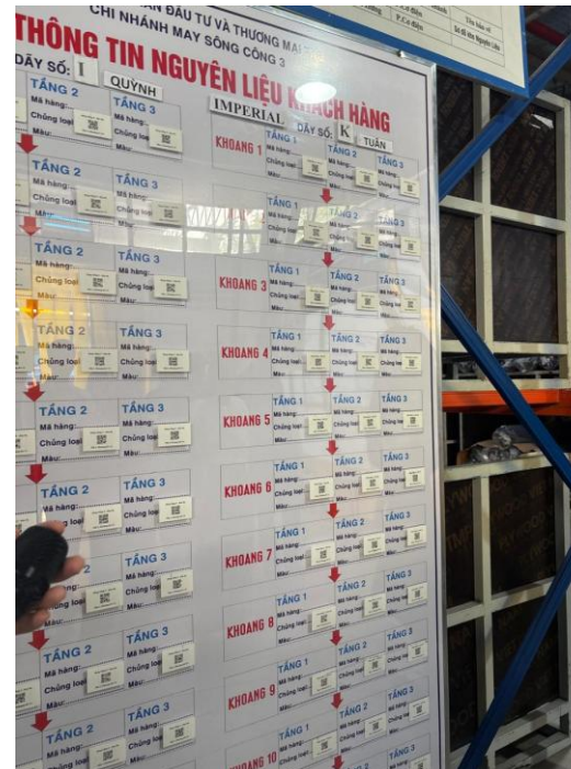
Kho nguyên liệu có mã QR code để theo dõi từng khoang/kệ, cảnh báo sức chứa & hỗ trợ truy vết
