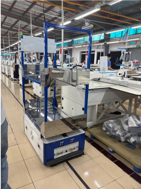
Robot dẫn đường thông minh, vận chuyển theo đường ray
