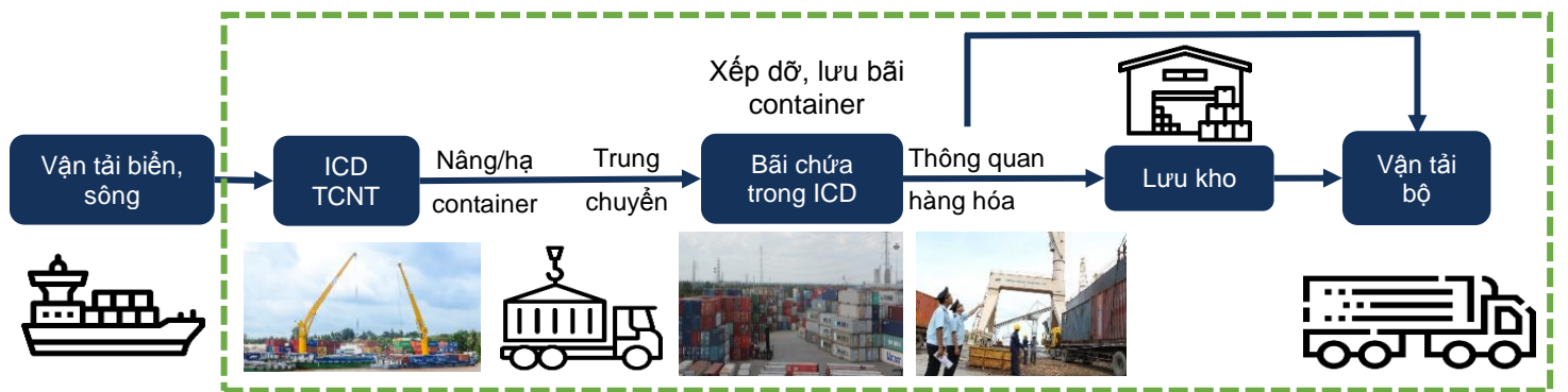
Hình 2: Quy trình làm hàng container tại ICD Tân Cảng Nhơn Trạch
