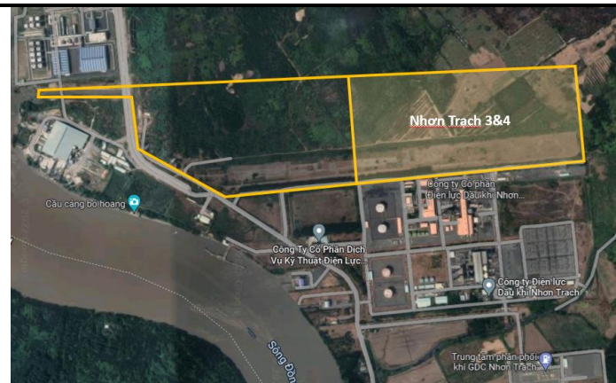
Hình 3: Nhơn Trạch 3&4 có tổng diện tích khoảng 35ha, công suất 1.600MW và suất đầu tư khoảng 19 tỷ đồng/MW
