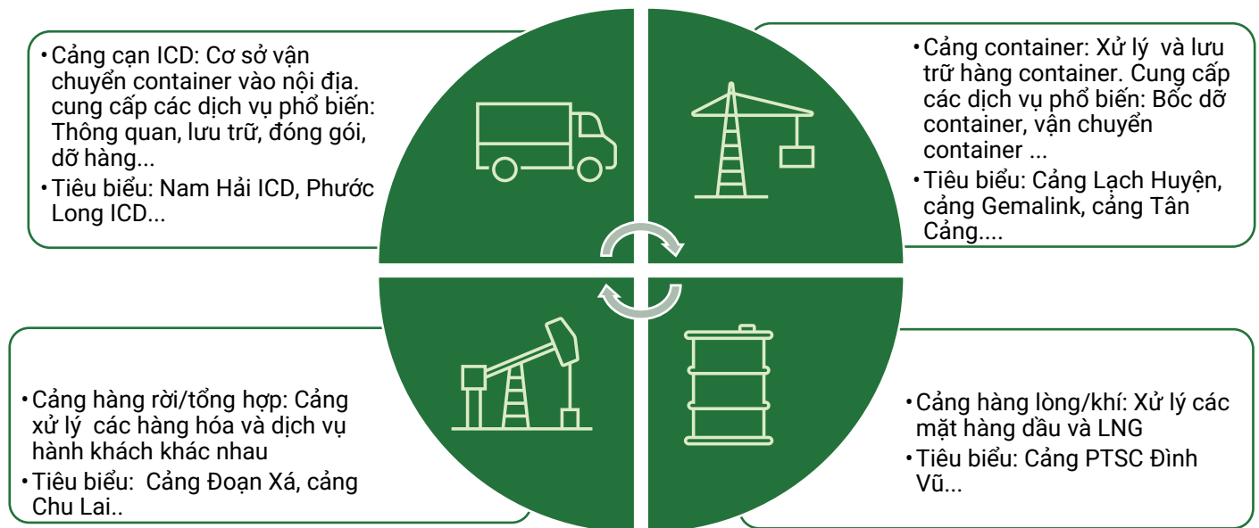
Hình 1: 4 loại cảng biển được phân loại dựa theo dịch vụ cung cấp
